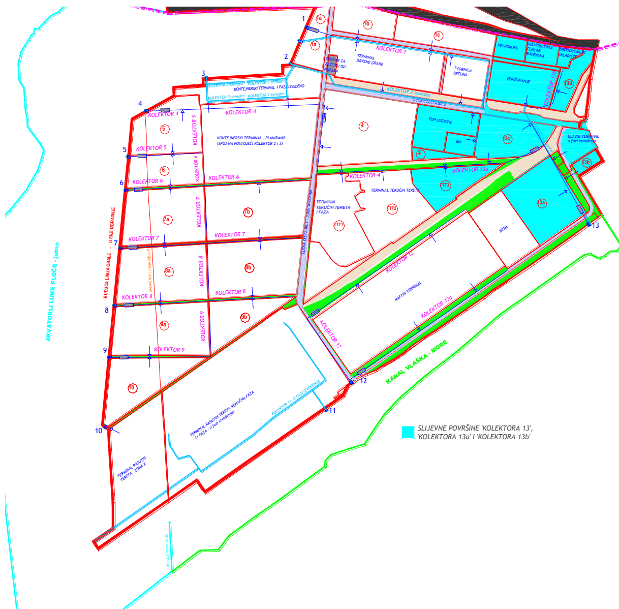
Slijevne površine (plava ispuna) – Kolektor 13
